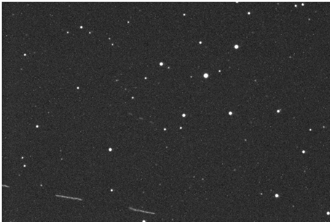
Exemplu de observații ale asteroidului NEO 2020 UA (dărele mai scurte din zona centrală) și ale satelitului MEO: ATLAS 2 CENTAUR R/B #23968U 96042B (dărele mai lungi din partea de jos), obținute cu telescopul Planewave CDK24 la Stația de Observații Feleacu a Observatorului Astronomic Cluj-Napoca, în data de 2020.10.20, UTC 20:41:49... 20:42:17, suprapunere de 3 imagini cu timpi de expunere = 3 sec. Coordonatele centrului imaginii: RA2000.0 04h 00m 17.4s; Dec2000.0 +11°00'40.1". CCD FOV: 23.88' x15.92'. Nordul este în partea superioară a imaginii.
